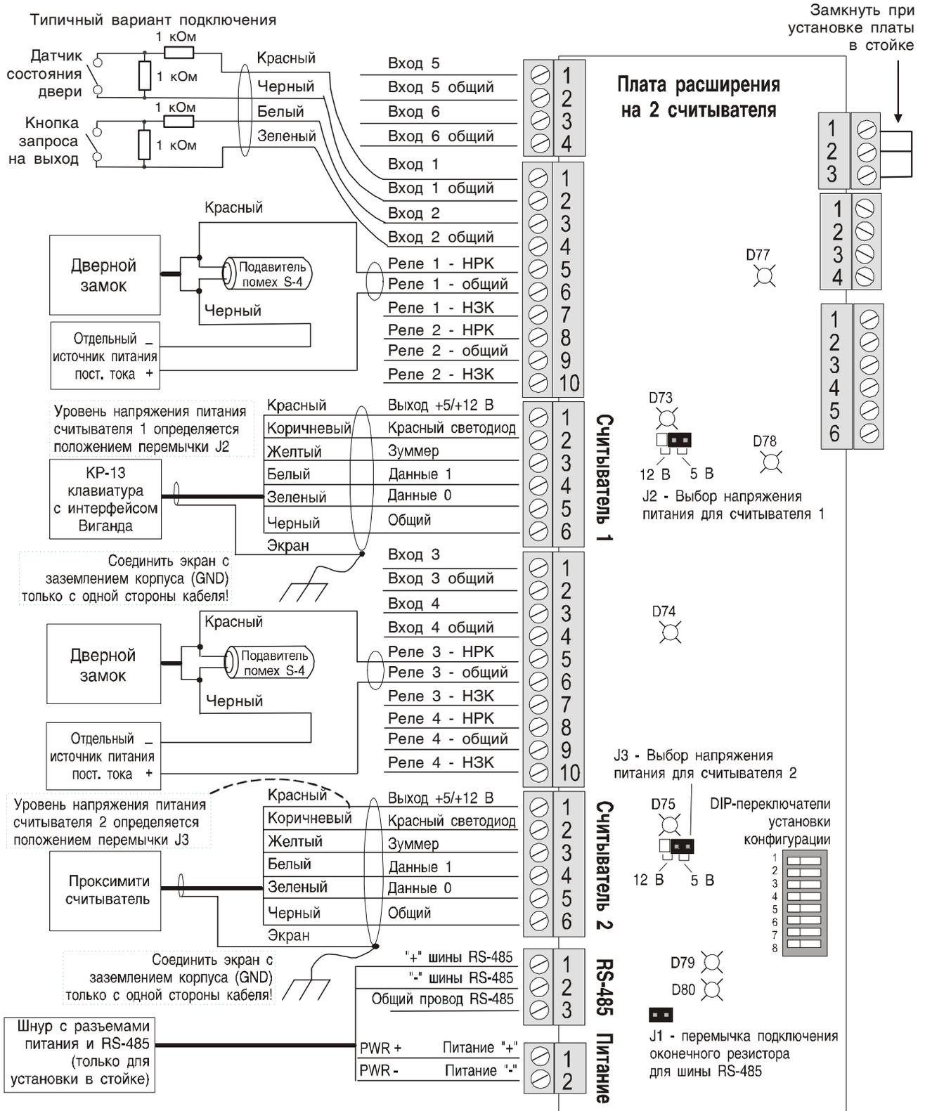
Примечание. Для подключения к N-485 соедините вместе провода синего цвета и используйте их как общий провод (сигнальное заземление). Используйте оранжевую пару проводов для передачи данных, соблюдая полярность подключения. На одном конце линии соедините внешнюю оплетку проводников с электрическим заземлением.
